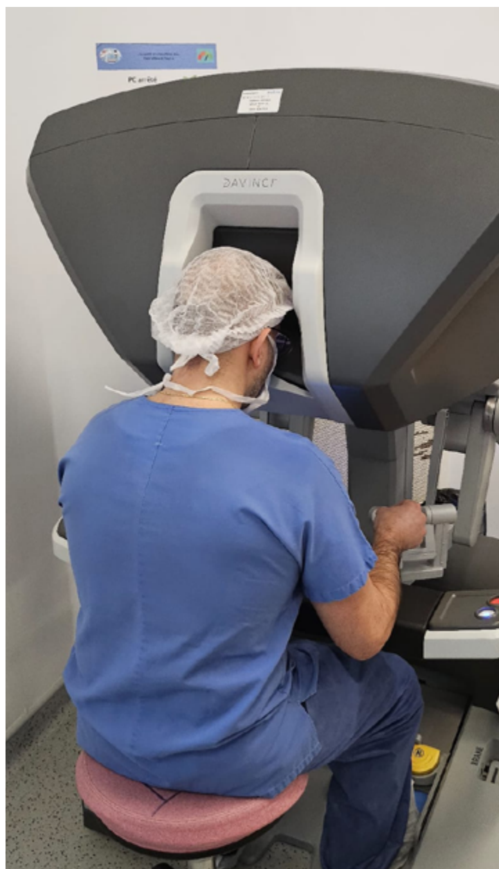
Station de contrôle du robot chirurgical
